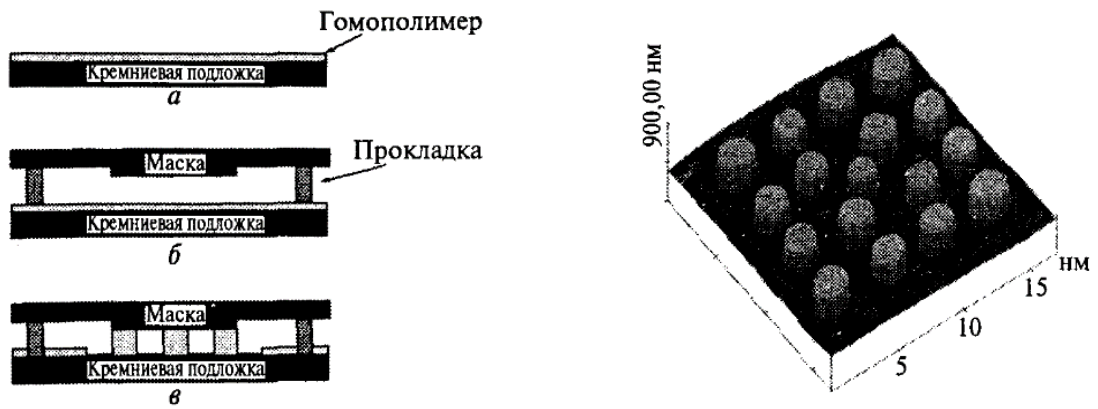
Схема литографически-индуцированной самосборки (ЛИС).
